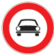
F.R 260058 transito vietato a tutti gli autoveicoli
