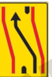
FCR 790412 A segnalazione carreggiata chiusa
