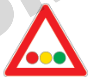
F.R 190 031 B semaforo con lanterne orizzontali
